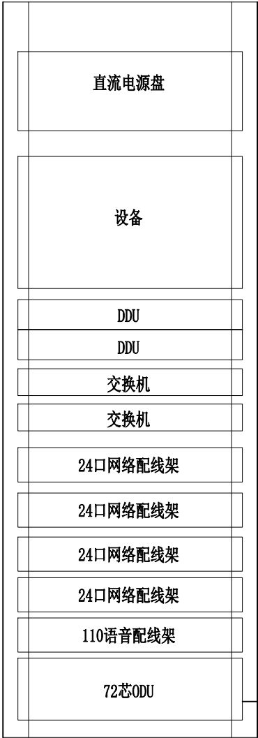
漳湾供电所1层机房 ZW01 机柜面板图
